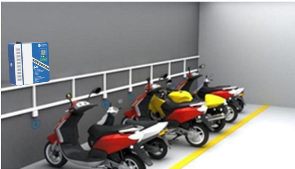
图2.2 KE-6711壁挂10口电动单车交流充电桩安装示意图
