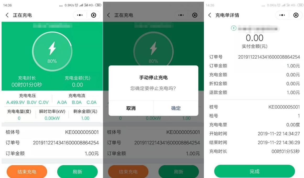
第五步：停止充电操作，在充电过程中，可随时点击“结束充电”
