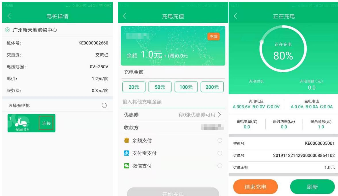
第四步：结束充电操作，打开手机 APP，进行结束充电操作；
